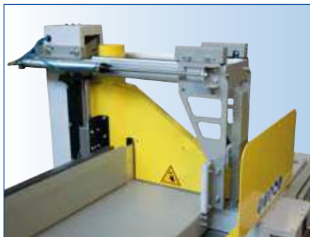
BGZ 00387 Doppio pressore frontale. Double front clamp (packer). Double presseur frontal (empaqueteur). 2 stk. Vordere niederhalter (stampler). Doble prensor delantero (empaqueador).
